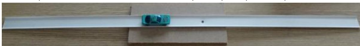
Il est constitué d'un capot de goulotte électrique de 80 cm, fixé en son centre (par deux vis) sur une planche en bois.
